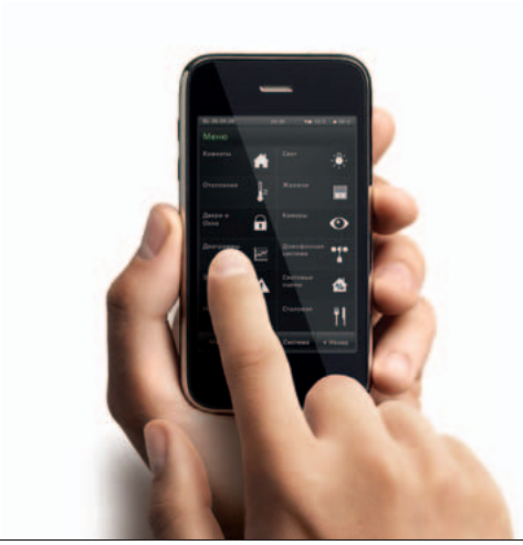
Приложение Gira HomeServer/FacilityServer для iPhone, iPad touch и iPad – простота управления инженерным оборудованием здания
