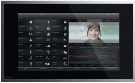
Gira Control 19 Client – сенсорный дисплей для управления инженерным оборудованием здания с помощью HomeServer 3 или FacilityServer
