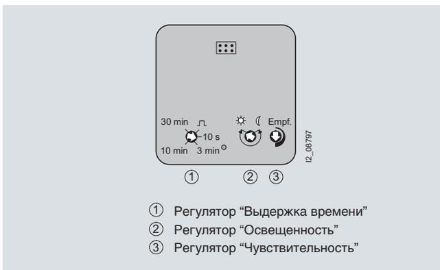
Пороговое значение освещенности представляет собой уровень освещенности, начиная с которого обнаруженное движение вызывает срабатывание датчика. Пороговое значение освещенности может устанавливаться в диапазоне ок. 0 – 80 люкс. Чтобы изменить пороговое значение освещенности, необходимо повернуть регулятор ② в требуемом направлении.
