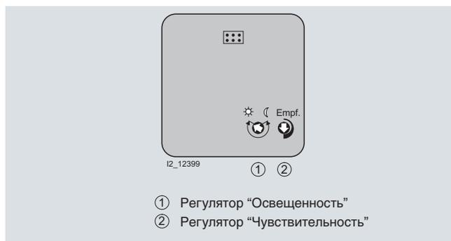
Детектор датчика движения обладает внутренним алгоритмом, который осуществляет автоматическую адаптацию к условиям окружающей среды. Таким образом, ложные срабатывания практически исключены. Обычно регулятор устанавливается на максимальную чувствительность.
