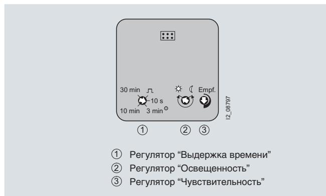
Выдержка времени определяет, как долго еще освещение останется включенным, если движение больше не регистрируется. Выдержка времени может устанавливаться в диапазоне ок. 10 с до ок. 30 мин. Установка осуществляется нелинейно, длинные отрезки времени могут задаваться только с относительно крупным шагом.
