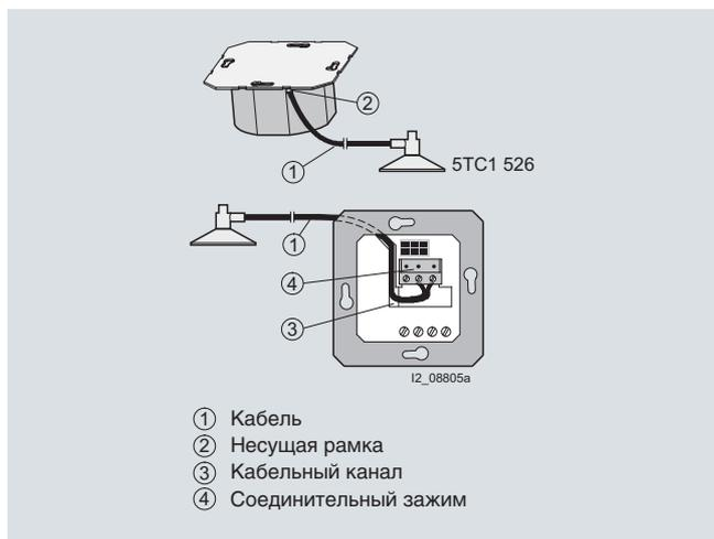
Штекер солнечного датчика отсоединяется. С отдельных жил кабеля датчика снимается изоляция и они вставляются в изоляционную трубку (входит в объем поставки солнечного датчика).
