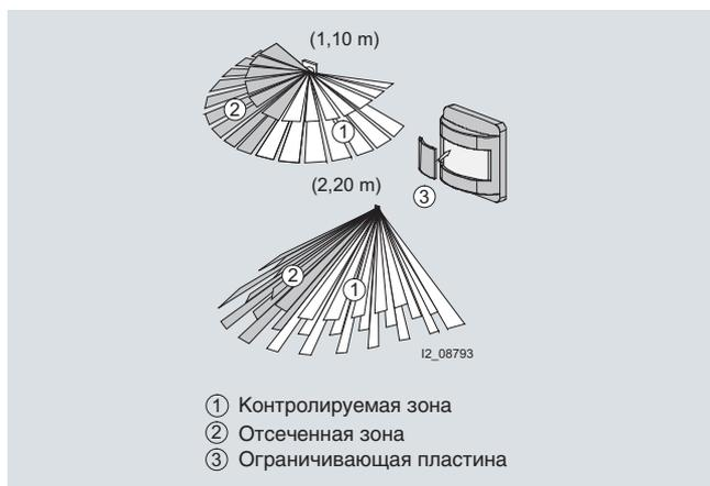
При помощи ограничительной шторки, за счет сужения зоны чувствительности, источники помех могут отсекаются. Шторка закрывает 90° левой или правой области контроля.
