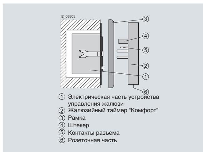
Электрическая часть устройства управления жалюзи ① устанавливается в монтажной коробке согласно DIN 49073 (Рекомендуется использовать глубокую монтажную коробку). При этом соединительные зажимы электрической части должны быть направлены вниз.
